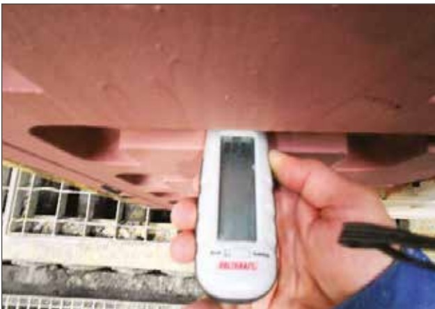
Abb. 2: Messung der Oberflächentemperatur der geschichteten Form
